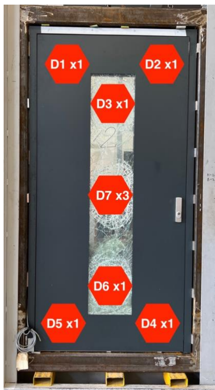
Badanie odporności na obciążenie dynamiczne. Schemat badania. D – kolejność uderzenia, X ilość uderzeń.
