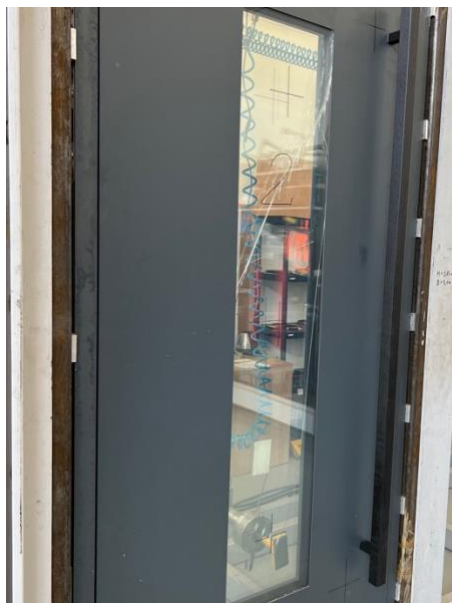
Badanie odporności na obciążenie statyczne. Widoczne uszkodzenia po badaniu. Spękania obciążanej tafli szkła
