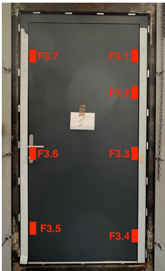
Obiekt badań Nr 1. Badanie odporności na obciążenie statyczne. Schemat badania.
