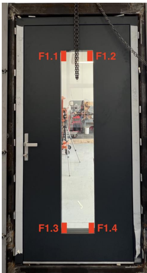
Obiekt badań Nr 2. Badanie odporności na obciążenie statyczne. Schemat badania.
