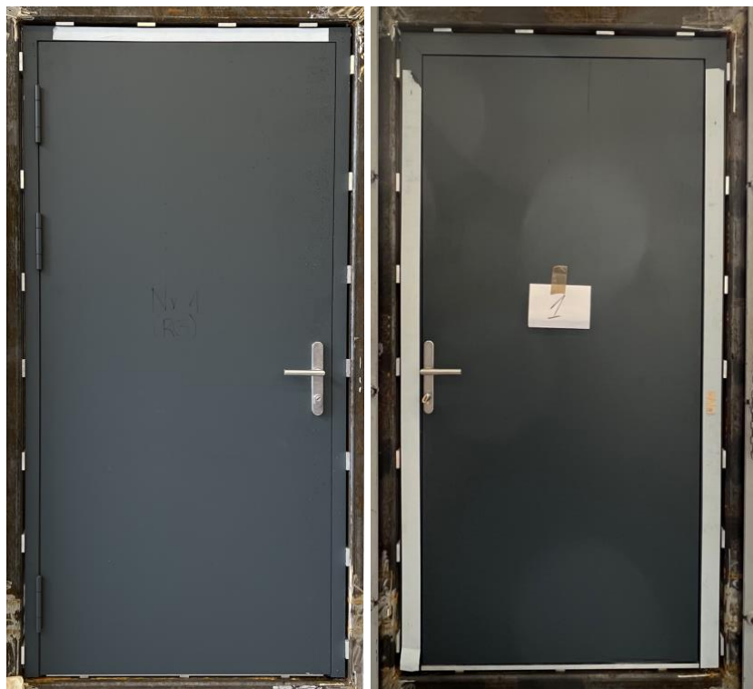
Fot. 1 i 2 Widok ogólny obiektu badań od strony atakowanej i nieatakowanej
