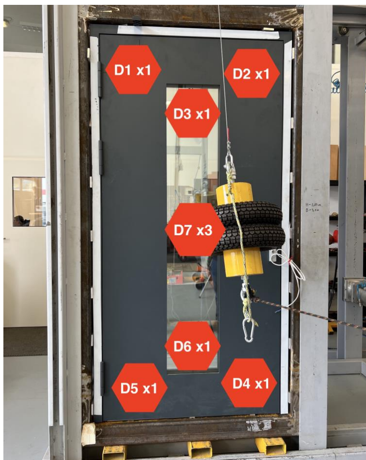
Fot. 1 Badanie odporności na obciążenie dynamiczne. Schemat badania. D – kolejność uderzenia, X ilość uderzeń.
